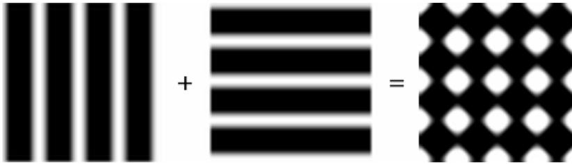
Abbildung 1.2: **Frequenztransformation.** Die Abbildung zeigt die Zerlegung eines Originalbildes (rechts) in zwei Basisbilder (links und Mitte). Die Summe der beiden Kosinus-Wellen der Basisbilder ergibt das Rautenmuster des Originalbildes. Mit einer entsprechenden Vielzahl von Basisbildern kann auch ein komplexes Bild (z.B. ein Foto) durch eine Frequenztransformation repräsentiert werden.
