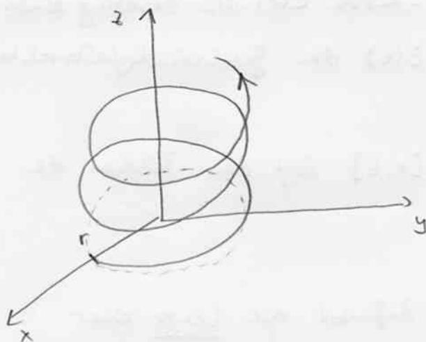
Überlagerung einer Kreisbewegung mit Radius  $r$  in der  $x$ - $y$ -Ebene mit einer linearen Bewegung in  $z$ -Richtung:
