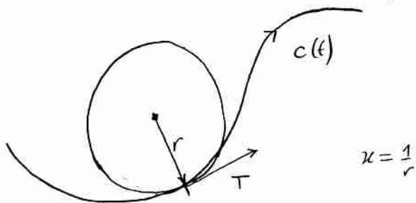
Der Schmiegkreis besitzt dieselbe Tangente und dieselbe Krümmung wie die Kurve.
