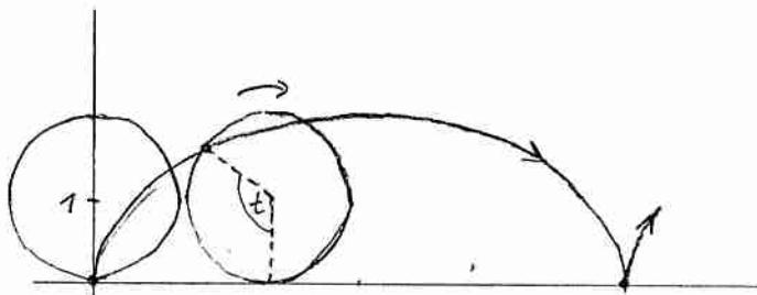
Kurve eines Randpunktes eines Kreises, der auf einer Geraden rollt.
