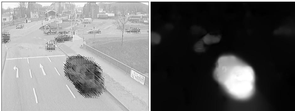
Abbildung 4: Ergebnis der Echtzeitberechnung für die *Rheinhafen-Sequenz* [IKS]. Links: Bild 1130 mit überlagertem Verschiebungsvektorfeld. Rechts: Betrag des Verschiebungsvektorfelds.
